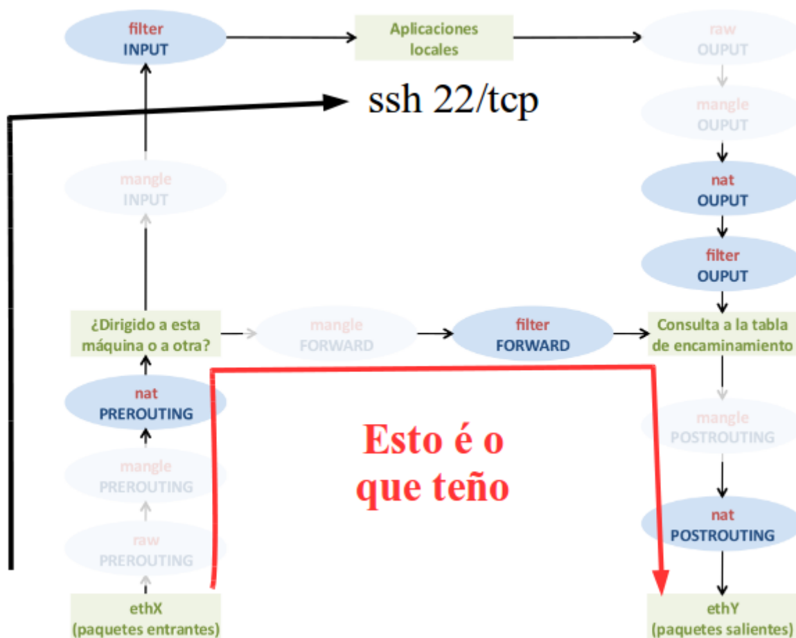
Fig. Conflictos de portos e funcionamento de netfilter.
